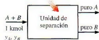
b) Separación completa de una mezcla de 1 kmol en sus componentes A y B
